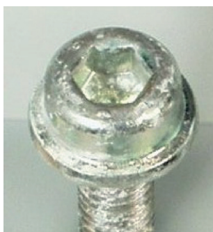
a) 彩虹色钝化锌层在240 h NSS测试后的白色腐蚀
