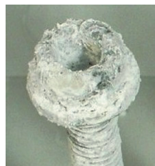
b) 彩虹色钝化锌层在480 h NSS测试后的严重白色腐蚀
