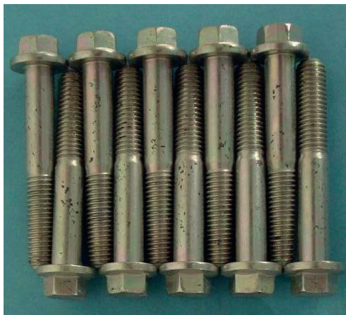
d) 测试中使用了彩虹色钝化锌层在240 h NSS测试后的黑点
